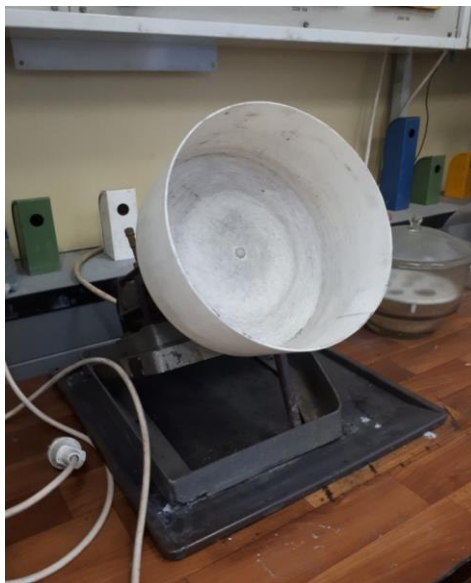
Рисунок 1 – Тарельчатый лабораторный гранулятор
