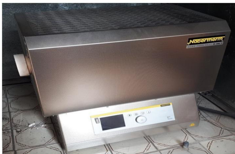
Рисунок 6 - Высокотемпературная трубчатая печь «RHTC 80 – 230/15 Controller B410»
